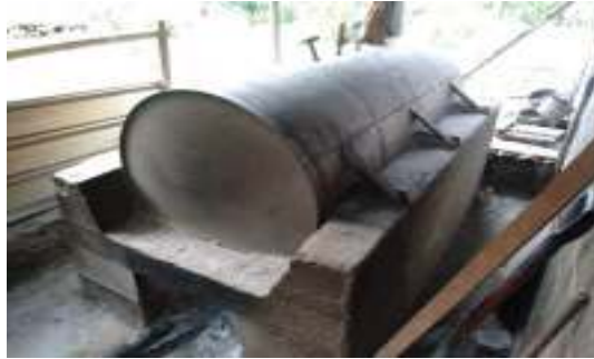
Gambar 1. Proses perebusan kedelai menggunakan tong
